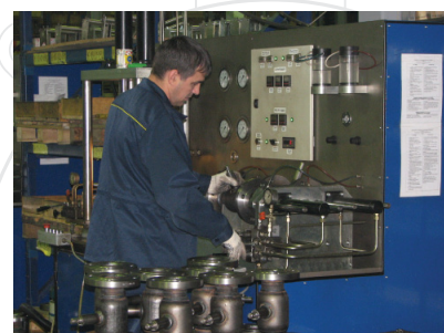
Тестирование шаровых кранов
