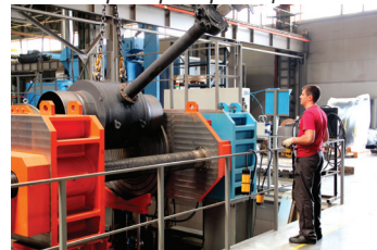
Тестирование шаровых кранов
